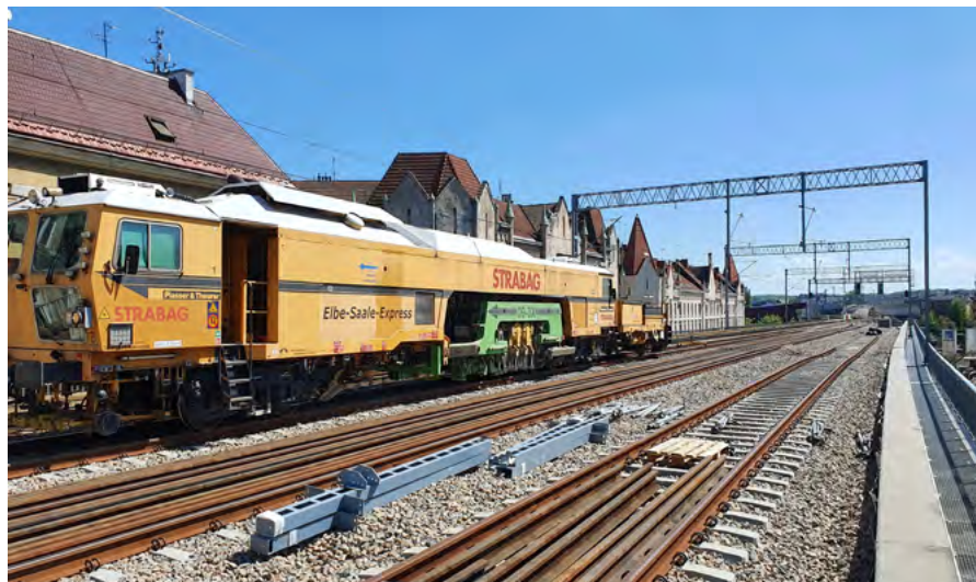
Fot. Podbijarka torowa CSM 09-3X oraz wózek GEDO podczas pracy na LK E30 w Krakowie
